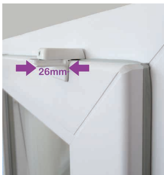
Montagebeispiel Überstand Trägerplatte Klemmträger bei Flügelstärke 19mm
