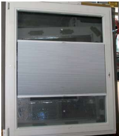
Anordnung des Plissees während der Prüfung
