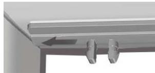
Schutzfolie der Klebträgerfläche vollständig abziehen und die Klebefläche nicht berühren um die Klebekraft nicht zu verringern. Klebplatte fest andrücken, nicht auf die Dichtung kleben. Klebplatte mit hoher Kraft mind. 20 Sekunden lang andrücken. Ideale Temperatur bei 20° - Wärme beschleunigt den Klebeprozess.
