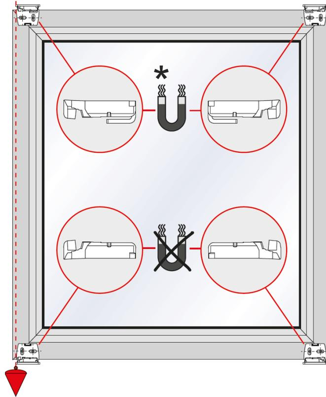
Position der Spannschuhwinkel entsprechend bestellter Anlagengröße gemäß Aufmaß
